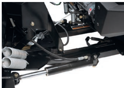
Двухцилиндровая гидравлическая система
